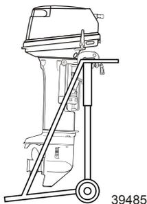
**ПРИМЕЧАНИЕ:** При переноске двигателя в горизонтальном положении держите силовую головку над гребным винтом.
