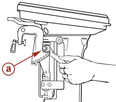
**a** - Рулевое управление второго водителя
