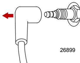
2. Снимите и проверьте свечи зажигания. Заменяйте свечи зажигания при износе электрода и при наличии шероховатостей, трещин, поломок или загрязненности изолятора.
