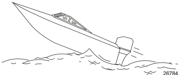
Самое главное в данной ситуации - обеспечить сохранение направления движения лодки в середине прыжка. В противном случае при приводнении лодка может резко повернуться в совершенно новом направлении. При таком резком изменении направления движения находящиеся в лодке люди могут быть выброшены из своих сидений или даже за борт.
